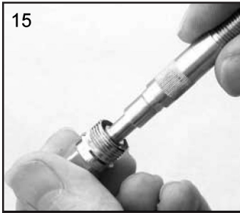
15. Coloque la junta en el alojamiento (10).
