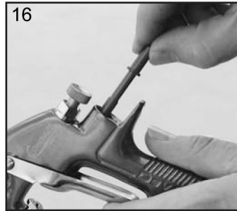
16. Vuelva a colocar el vástago (11).
