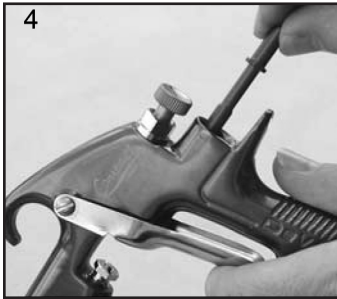
4. Retire la válvula (11).
