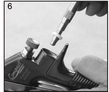
6. Retire el asiento de la válvula.
