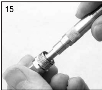
15. Coloque la junta en el alojamiento (10).
